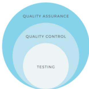
Рис. 1. Взаимосвязь обеспечения качества, контроля качества и тестирования
